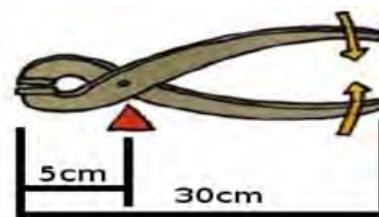
17. Calcular la fuerza que tendré que hacer para mover una piedra de 90 Kg con la palanca mostrada en la figura. ¿De qué grado es dicha palanca?
