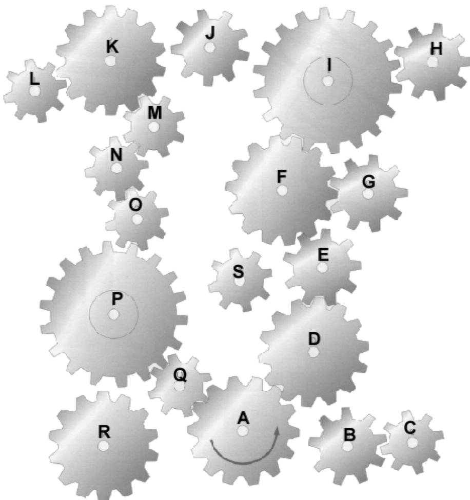
25. En el siguiente montaje el motor gira en el sentido indicado por la flecha.
