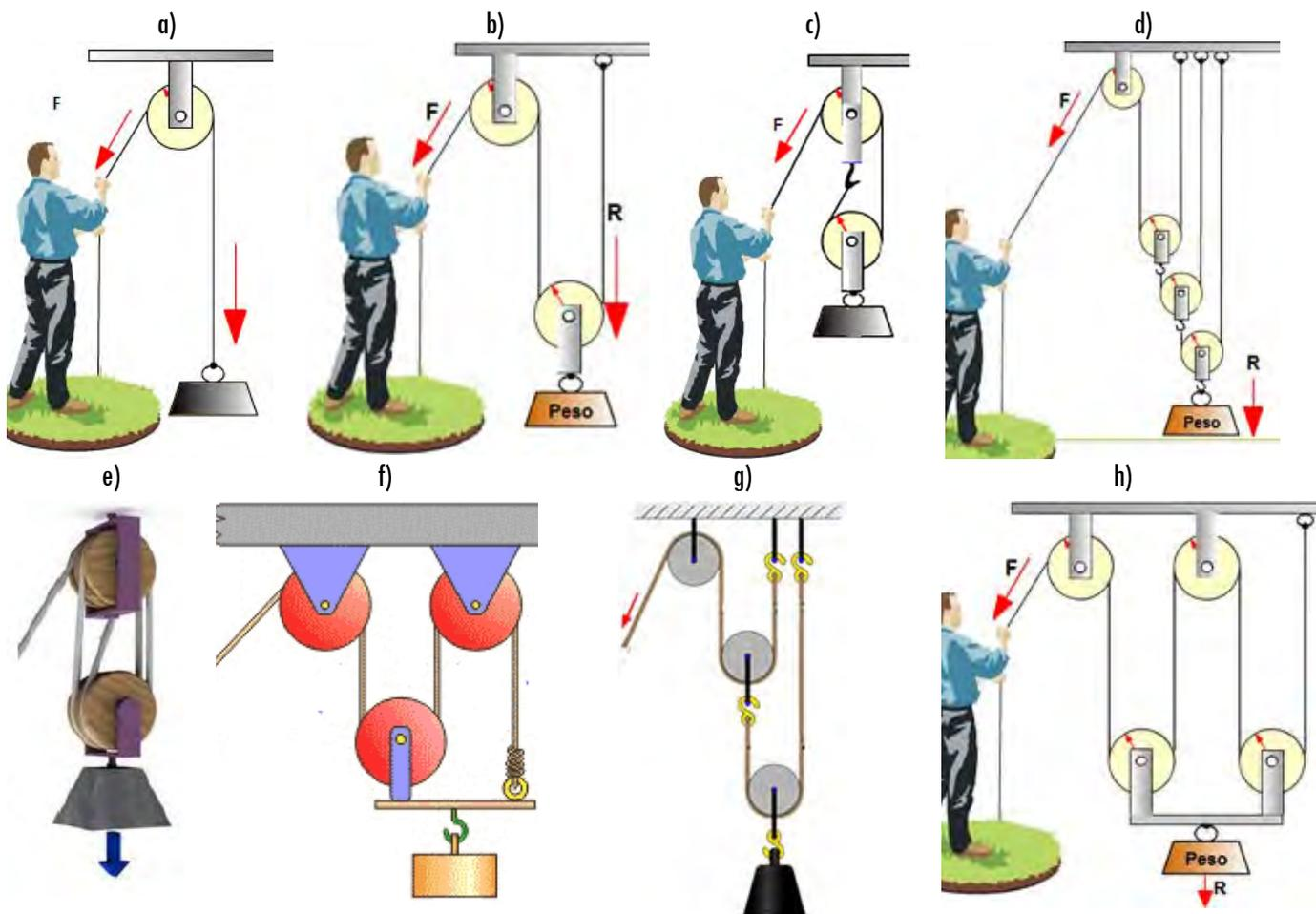
21. Dados los siguientes mecanismos de transmisión circular indica el sentido de giro de cada una de las poleas. Además, para cada polea indica si gira a menor, igual o mayor velocidad que la polea motriz. (se marca con una M la polea motriz).
