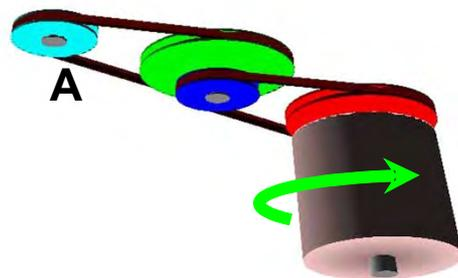
26. En el siguiente mecanismo la potencia total del motor se distribuye a tres árboles conducidos distantes (A,B y C), mediante transmisiones por correa.
