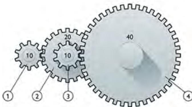
41. En la figura se muestra un exprimidor de fruta. El eje del motor, que mueve un engranaje de 10 dientes gira a 1800 rpm.
