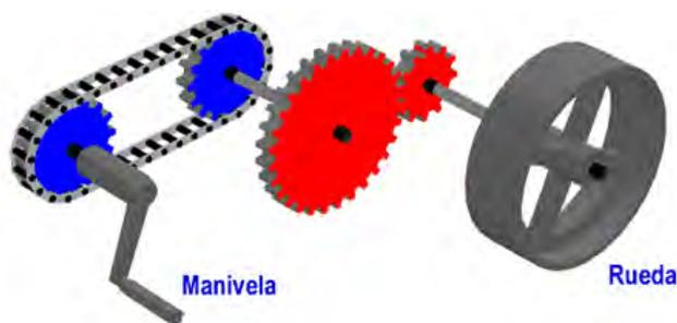
29. En la figura se muestra el sistema de transmisión por cadena de las cuatro ruedas motrices de un coche de juguete.
