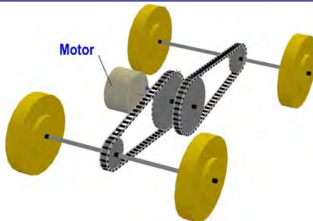
30. El siguiente mecanismo está formado por dos sistemas de transmisión.
