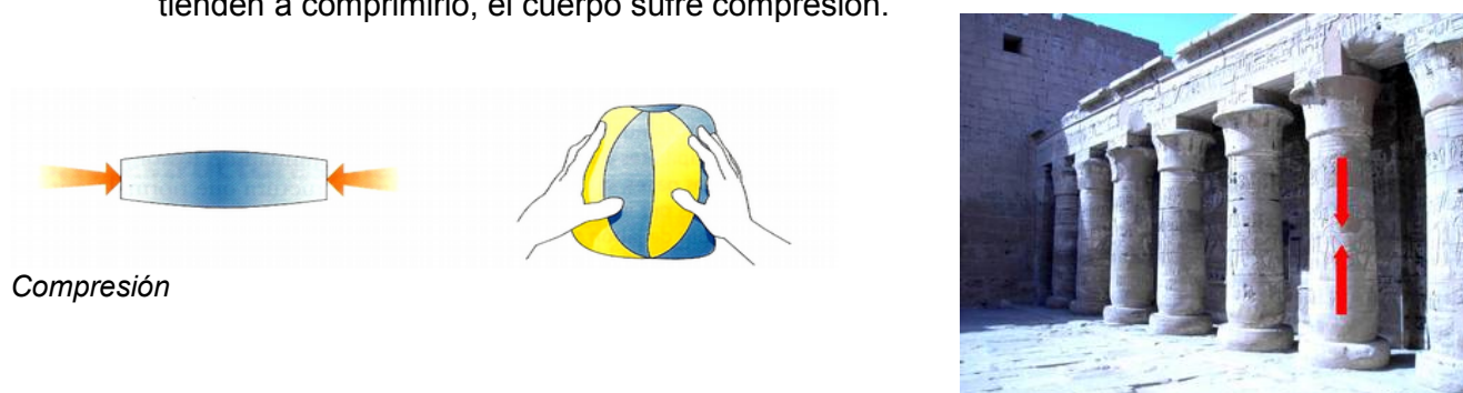
Los pilares soportan el esfuerzo de compresión
