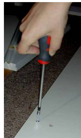
Tanto el tornillo como la punta del destornillador están sufriendo torsión
